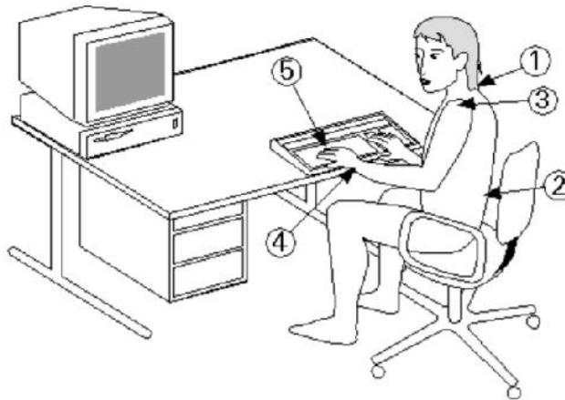
Figura 2.1.1. Posturas inadecuadas más frecuentes en el trabajo desde casa (Teletrabajo) : 1 giro de la cabeza; 2 falta de apoyo en la espalda; 3 elevación de hombros debido al mal ajuste de la altura mesa-asiento; 4 falta de apoyo para las muñecas y antebrazos; 5 extensión y desviación de la muñeca al teclear. **¿Reconoce algunas como propias?**
